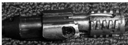
Затвор карабина «Ремингтон 742». В более поздней модификации «Ремингтон 7400» количество боевых упоров было сокращено до 4-х
